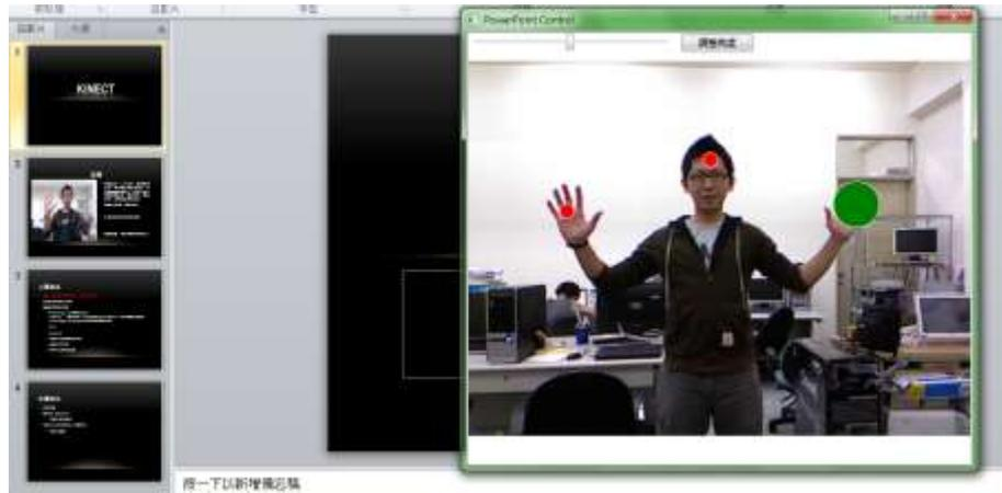
滑鼠操控:使用掌心座標，做滑鼠的移動。目前用預測路徑法來大幅降低操控時滑鼠抖動情況。下圖左邊是使用顏色來區分不同使用者，圖中紅色筆畫代表滑鼠移動的軌跡。
