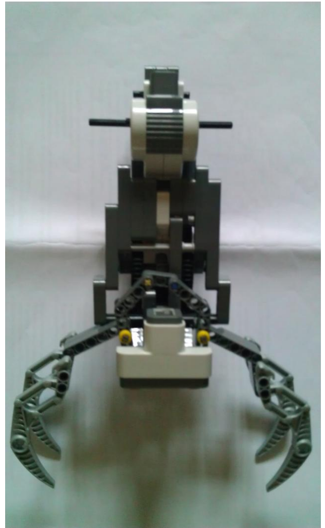
加上超音波感應器(偵測距離)
