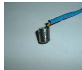
Fig. 4b. The LVDT.
