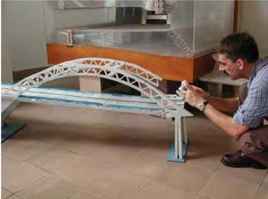
照片 27 同濟大學風洞試驗之模型(1/4)
