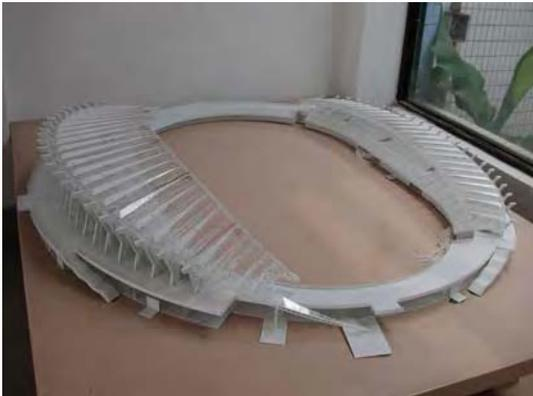
照片 29 同濟大學風洞試驗之模型(3/4)
