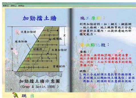
圖 4 加勁擋土牆施工原則與優缺點比較
