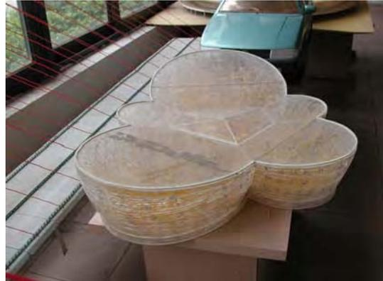
照片 28 同濟大學風洞試驗之模型(2/4)
