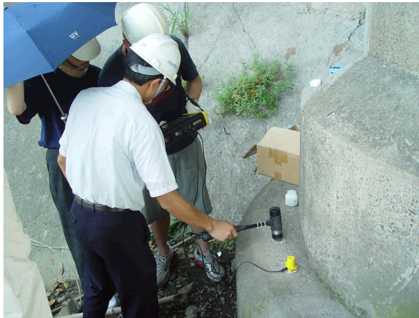
圖六 現地 P1 沉箱受衝擊反應檢測之情形
