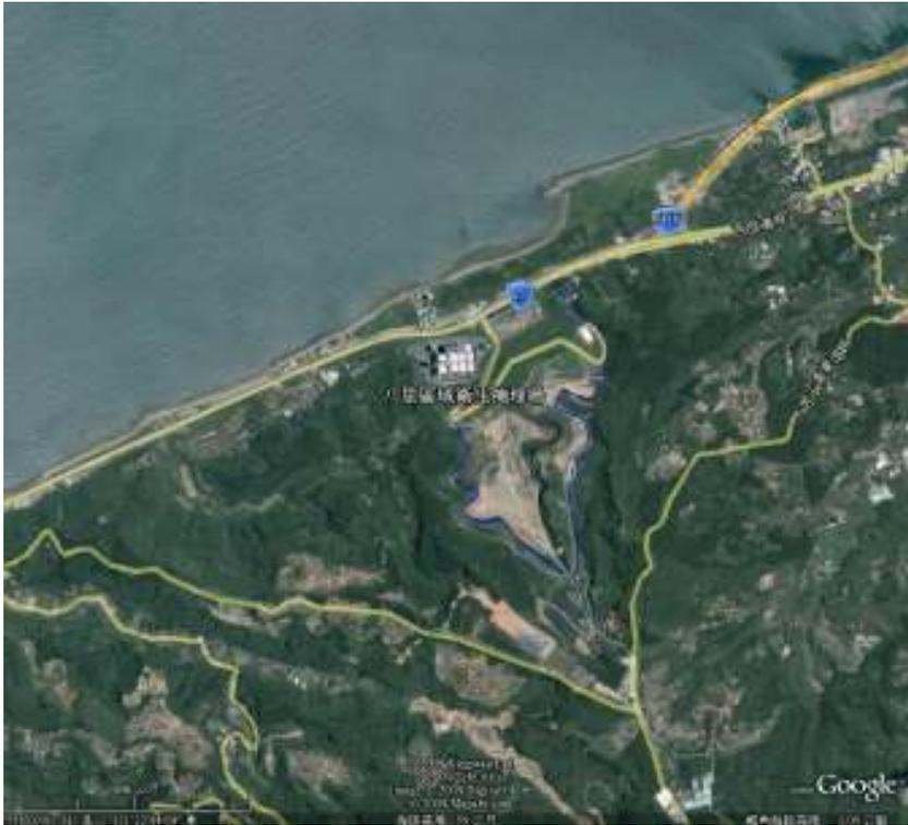
圖4-24所示為八里區域衛生掩埋場，位於西部濱海公路沿路上，臨近海岸線，以Google Earth測量功能，量測結果離海僅約300公尺遠，且旁邊設有焚化廠，對於移除清理相當便利。
