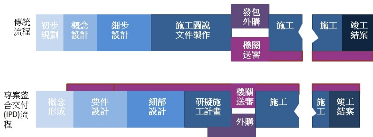
圖2-20、營建工程傳統流程與專案整合交付(IPD)流程之比較[68, 69]
