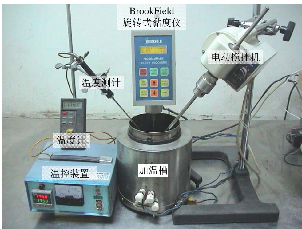
图2 本研究依ASTM D2669组装的橡胶沥青175℃视黏度量测设备
