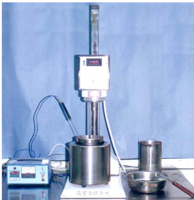
图1 本研究拌制橡胶沥青所用的高剪力拌合机与加热设备
