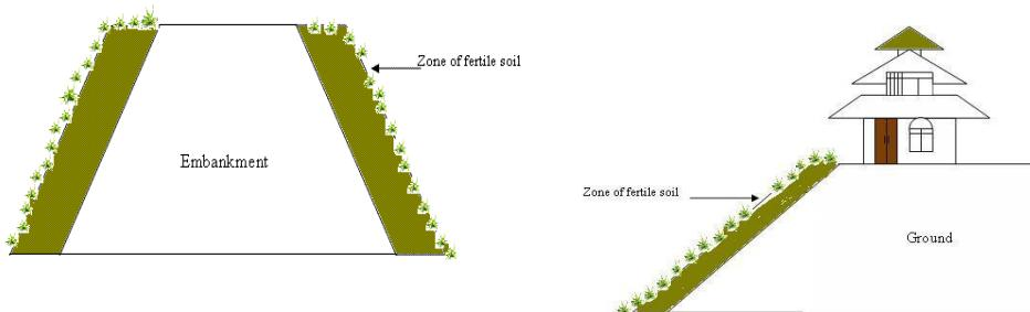
圖 1 土方構造物之邊坡沃土區示意
