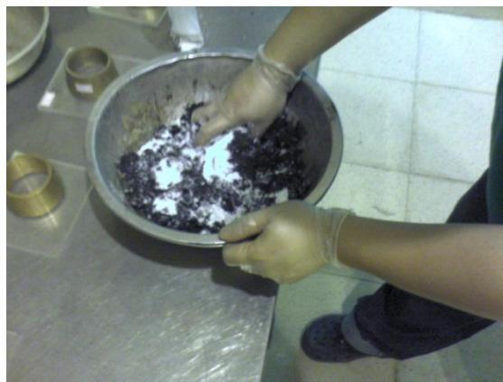
圖 3 污泥-石灰之調製情形
