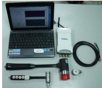
圖二 本實驗室自行開發組裝之衝擊反應監檢測系統
