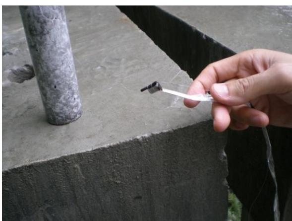
圖五 垂入埋藏式感測器之照片二
