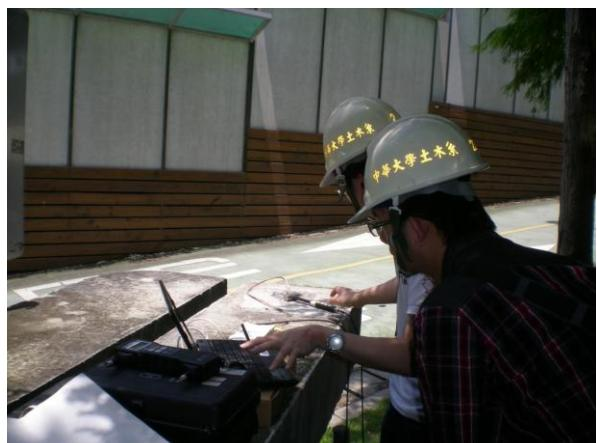
圖八 對現場小型含樁帽基樁進行敲擊反
