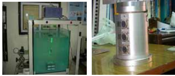
圖 8 水洞雷射測驗台原型流場觀察測試段及三分力矩測定儀
