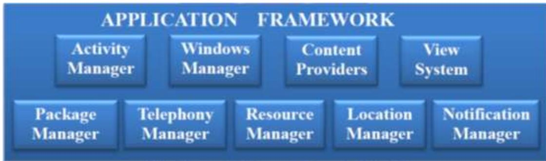
圖 3-11 Android 系統應用程式層設計(Applications)。
