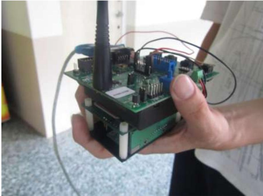
圖 3-69 nRF9E5 IMU 移動設備
