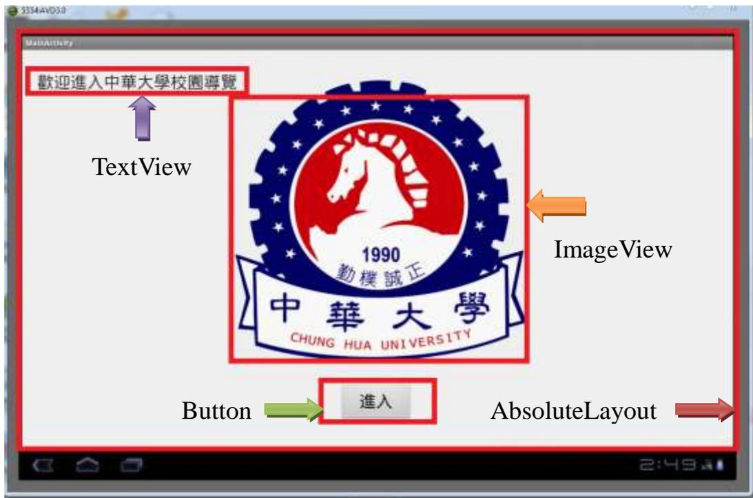
圖 3-19 main.xml 介面佈局顯示畫面
