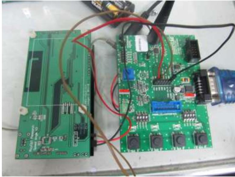
圖 3- 54 IMU 以及 nRF9E5 總成圖
