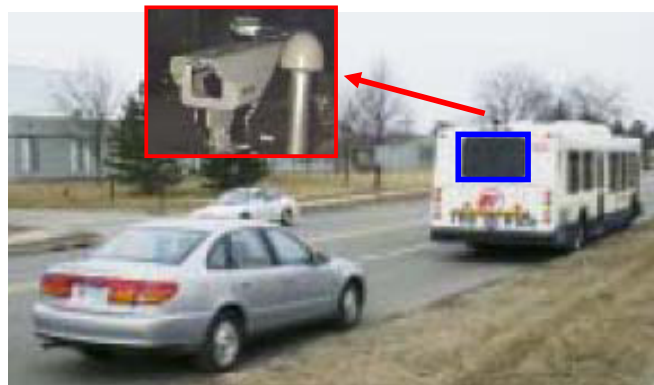
圖3 公車後方之感應器(圖中紅框)及警示資訊螢幕(圖中藍框)
