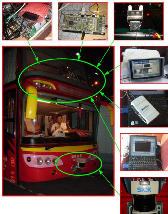
圖 24 大客車縱向防撞警示系統之硬體配置圖 (資料來源：子計畫三提供)
