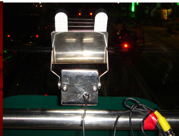
圖 17 拍攝前方車況攝影機之裝設狀況
