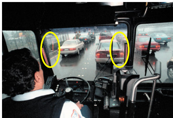
圖 2 擋風玻璃兩側裝之光棒設備
