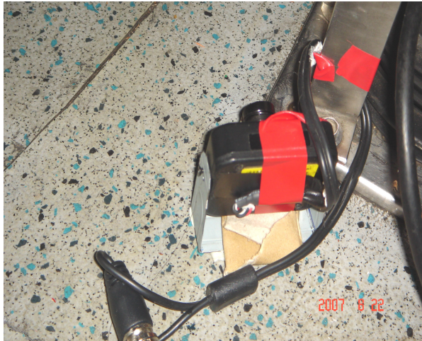
圖 18 拍攝司機腳部攝影機之裝設狀況
