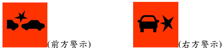
圖 27 HUD 警示圖形 (前方警示與右方警示) (SAE,2003)
