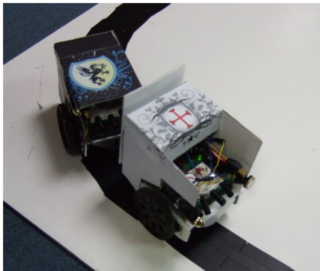
圖三十一、運用 IR sensor 及 IR LED 進行無人跟車。
