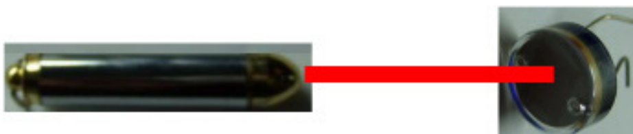
圖二十五、光敏電阻運用之一，可用於射擊遊戲或保全系統之運用。
