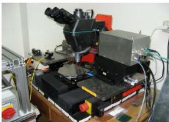
圖 7 顯微鏡 I-V 電性量測探針平台
