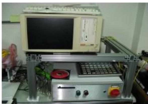
圖 6 Keithley 4200 IV 電性量測儀
