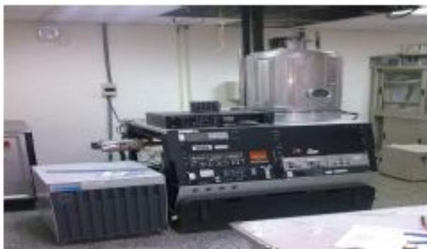
圖1 電子槍 (E-gun) 蒸鍍設備
